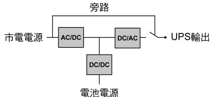
本產品屬於雙重轉換設計在線式不斷電系統 UPS 可為重要負載，如：電腦系統等，提供完善的電源保護，亦可過濾來自市電電源的干擾。電源經由 UPS，其輸入電源波型可被調整為與市電雷同的波型，係屬高功率因數的電源系統。此外，透過複合晶片技術(PWM)，其輸出電源可達純正且穩定的正弦波波型。
